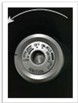
Pour ouvrir le siège, placez le véhicule sur la béquille latérale ou la béquille centrale. Tournez ensuite la clé d'un quart de tour vers la gauche.
