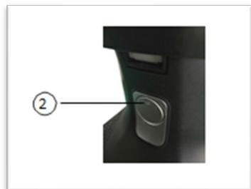
La prise de charge (2) est située à l'avant du siège et est directement connectée à la batterie (principale ou en option, selon la position de l'interrupteur d'alimentation, voir p. 18).
