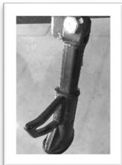
La béquille latérale est située sur le côté gauche du véhicule. Relâchez la béquille latérale en utilisant votre pied pour monter sur le support de la béquille latérale et mettre le véhicule en position verticale.
