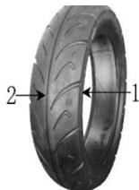
Vérifiez l'indicateur d'usure de la bande de roulement (1) qui est un triangle imprimé sur le côté du pneu.
